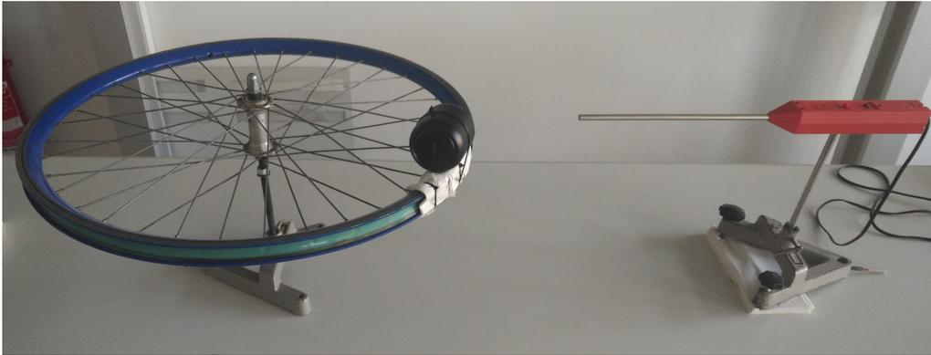
Abbildung 5.11: Aufbau des Analogieexperiments zur Messung der Rotationsgeschwindigkeit.
