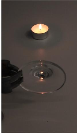
(a) Experimenteller Aufbau mit einem Teelicht als Lichtquelle und einem eingespannten Weinglas-Fuß.
