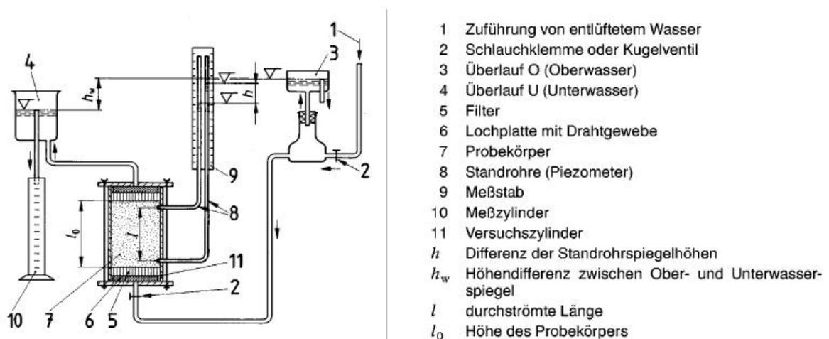
Abbildung 7: Versuchsanordnung für den Versuchszylinder mit Standrohren [13]
