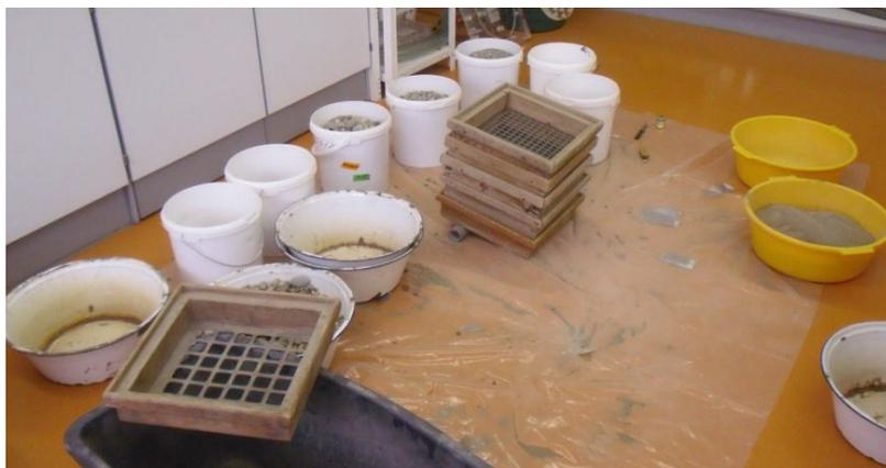
**Abbildung 11: Aufbau und Geräte des Siebversuchs**
