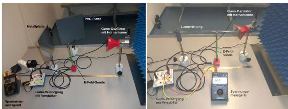
Bild 13.1: Die Versuchsteile »Wellenlängenbestimmung an stehenden Mikrowellen« (links) und »Mikrowellen in einer Lecherleitung« (rechts).
