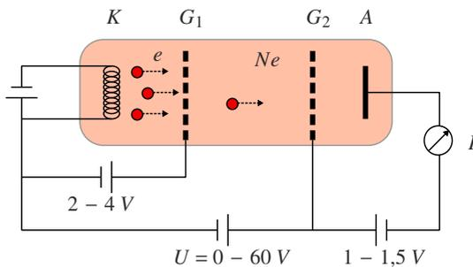
Bild 20.2: Schematischer Aufbau der Franck-Hertz-Röhre: A Auffänger 1 bis 1,5 V negativ gegen **G<sub>2</sub>**, fest eingestellt; **G<sub>2</sub>** Beschleunigungsgitter, Spannung regelbar; **G<sub>1</sub>** Raumladungsgitter 2 bis 4 V positiv gegen **K** - fest eingestellte Kathode.
