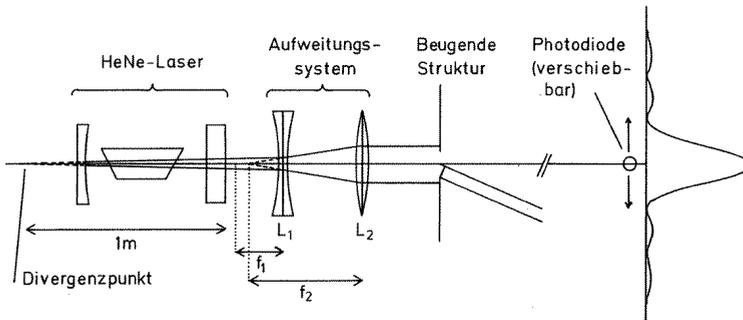
Bild 18.9: Strahlengang für den Versuch »Beugung mit Laserstrahlung«
