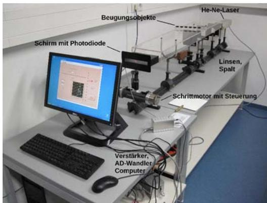
Bild 18.1: Der Versuch »Beugung und Interferenz von Laserstrahlung«.
