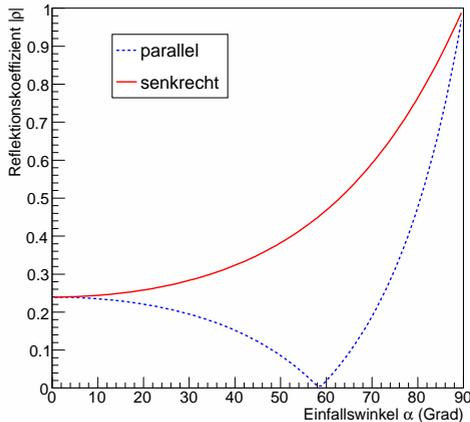
Bild 17.3: Reflexionsvermögen in Abhängigkeit vom Einfallswinkel für  $n = 1,63$ .
