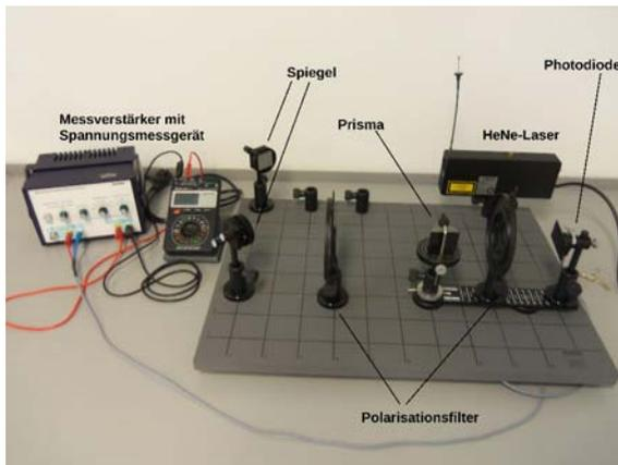
Bild 17.1: Der Versuch »Fresnelsche Formeln und Polarisation«.
