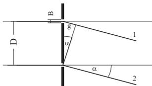
Bild 18.3: Beugung an zwei punktförmigen Öffnungen.
