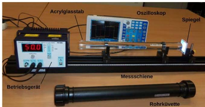
Bild 15.1: Der Versuch »Messung der Lichtgeschwindigkeit«.
