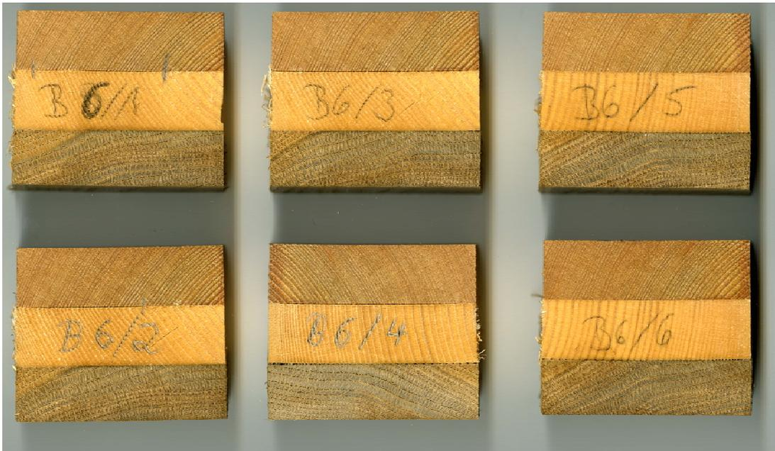
**Abbildung 1: Prüfkörper (EPI-Klebstoff) nach temperierter Wasserlagerung (ift-Richtlinie HO-10/1)
