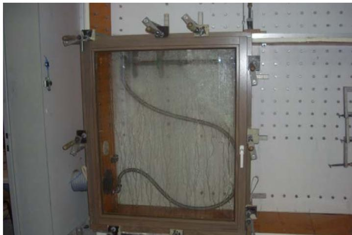
Abbildung 8: Musterfenster während der Eignungsprüfung „Schlagregendichtheit“
