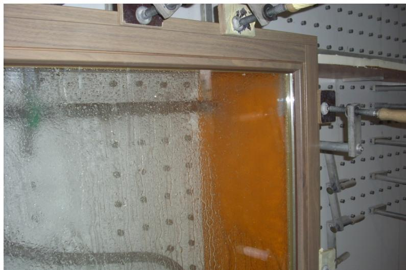
Abbildung 9: Schlagregensimulation während der Eignungsprüfung „Schlagregendichtheit“
