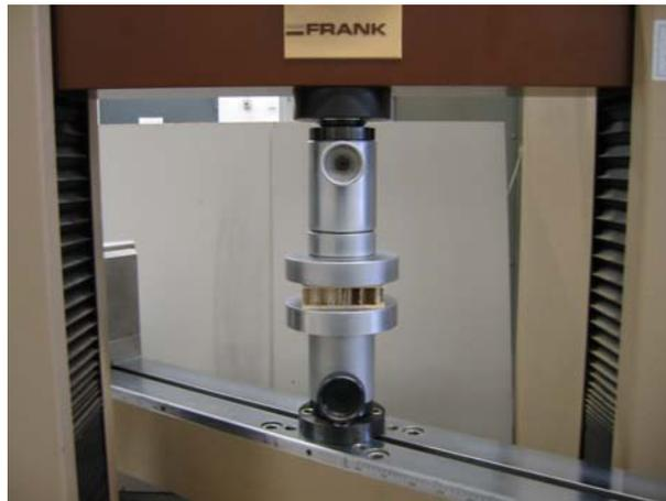
Abbildung 25: Versuchsaufbau Druckprüfung, Stempel  $\varnothing$  100 mm
