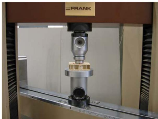
Abbildung 26: Versuchsaufbau Druckprüfung, Stempel  $\varnothing$  30,5 mm
