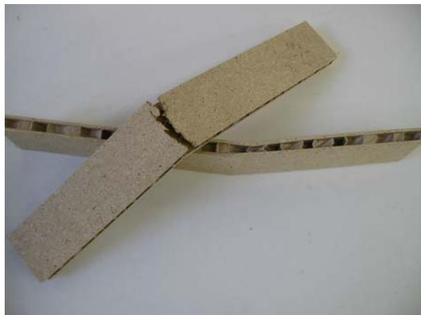
Abbildung 36: Quetschungen des Wabenkerns durch Biegung
