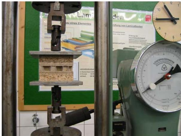
Abbildung 24: Versuchsaufbau Querzugprüfung
