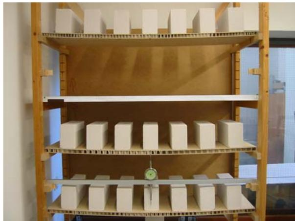
Abbildung 28: Versuchsaufbau Zeitstandfestigkeit
