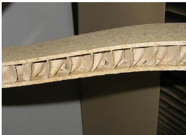
Abbildung 32: Internes Aufreißen der Waben bei Biegung
