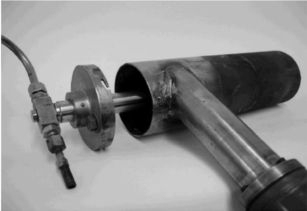
Abb. 16 Düseneinsatz mit Sekundärluftrohr
