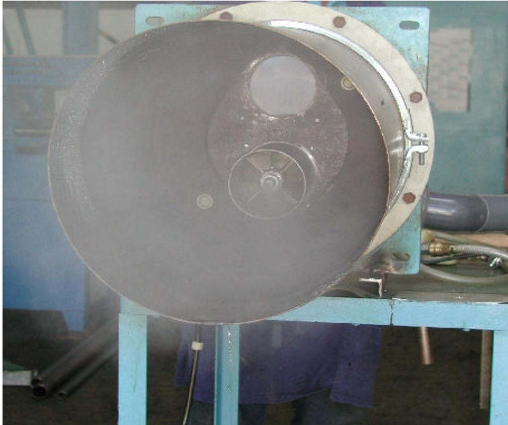
Abb. 20 Zerstäubungsversuche im offenen Verbrennungsrohr mit Wasser
