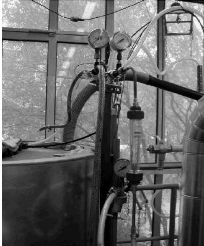
Abb. 30 Schwebekörper- Primärluftdurchflussmesser
