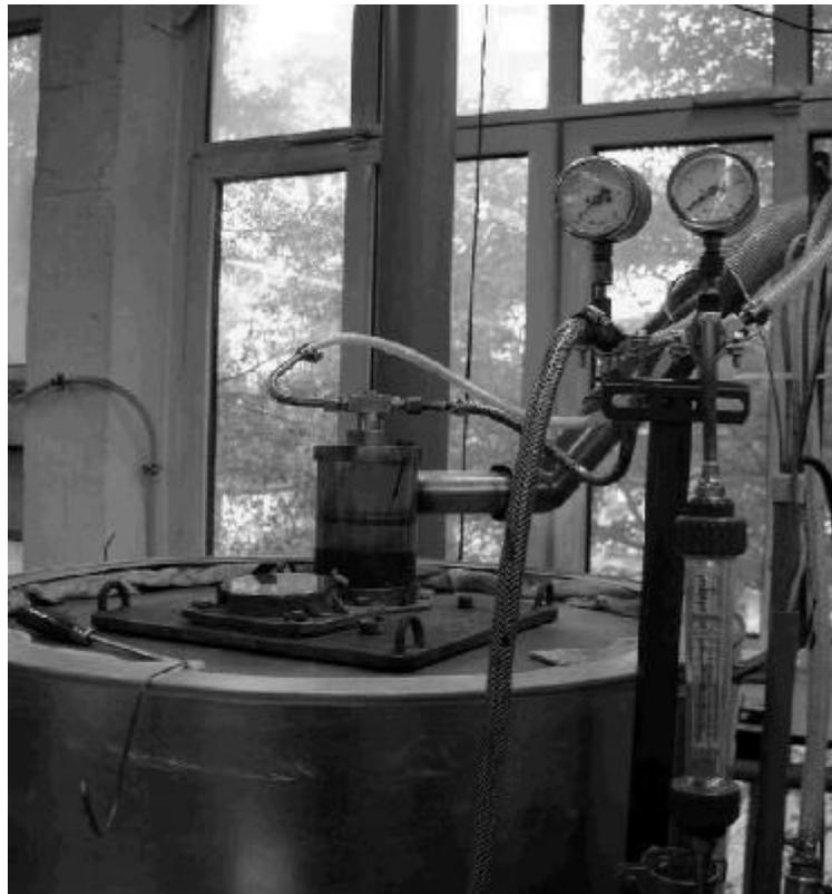
Abb. 26 VVA mit Zuführungsleitungen für P-Öl, Primär- und Sekundärluft
