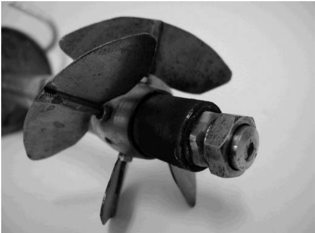
Abb. 17 Düseneinsatz mit Sekundärluftdralleinrichtung
