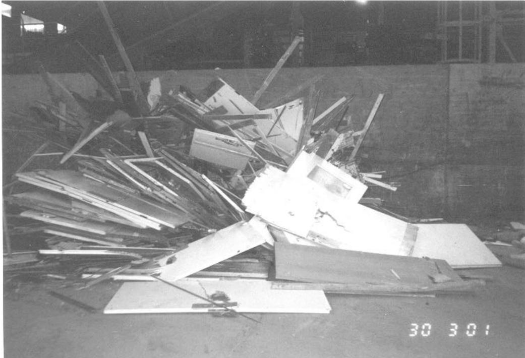
Abb. 1 Holz der Holzklasse H3 nach der Mischung und Vorsortierung
