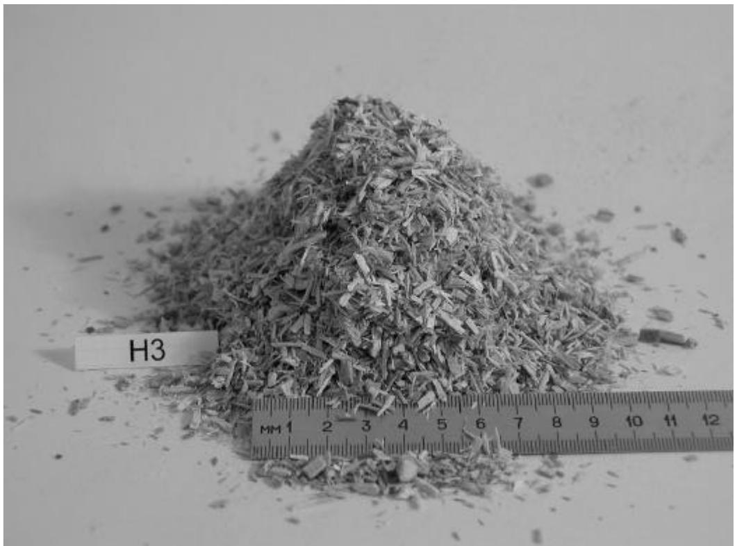
Abb. 4 Holz der Holzklasse H3, zerkleinert für die Pyrolyse
