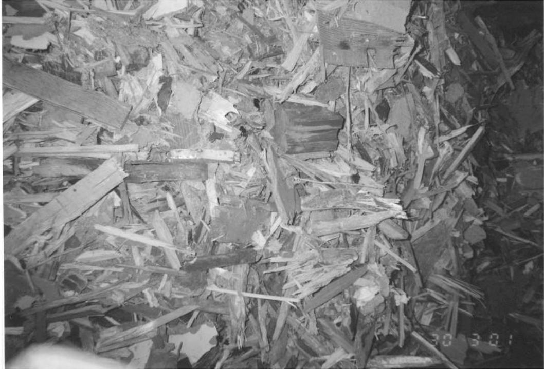
Abb. 3 Holz der Holzklasse H3 nach dem Schreddern
