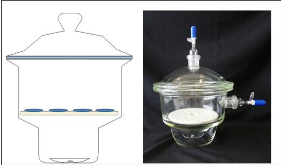
Abb. 22: Exsikkator für eine gesättigte Quecksilberatmosphäre, links eine Skizze mit angedeuteten Quarzprobenträgern auf der Porzellanplatte, sowie rechts eine Fotografie vom selbigen Aufbau (Skizze und Fotografie: BÖTTGER)
