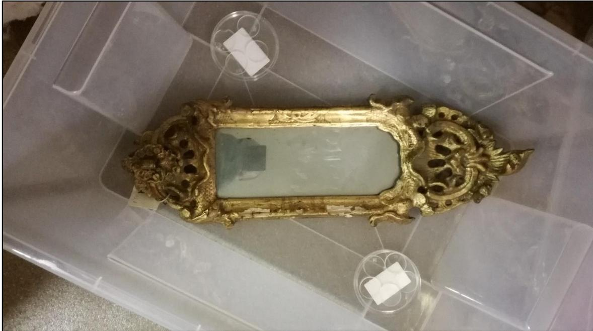
**Abb. 61: Amalgamspiegel und präparierte AgNPs auf den Probenträgern zusammen in der Kunststoffbox**
