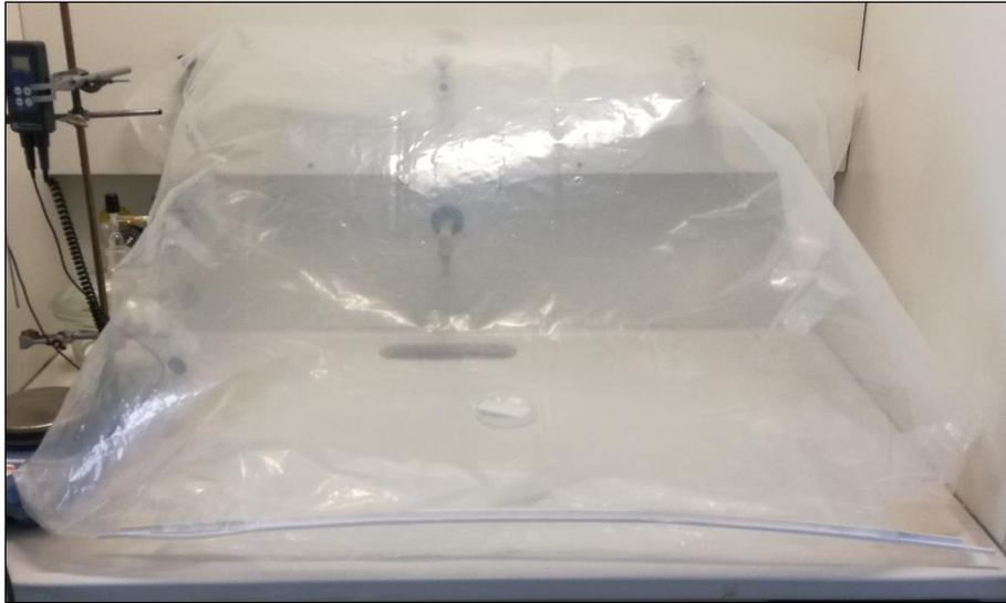
**Abb. 24: Der Handschuhbeutel unter dem Abzug, aufgeblasen mit Druckluft und befüllt mit Quecksilbergas; in der Mitte ist die Petrischale mit N=5 Probenträgern zu erkennen (BÖTGER).**
