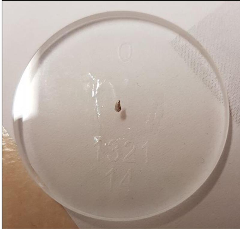
**Abb. 52: AgNPs mit Cr(IV) nach der Mikro-RFA-Aufnahme ausgeschnitten und auf einem Quarzprobenträger ( $\varnothing = 30$  mm) platziert (Probe A1005-1715).**
