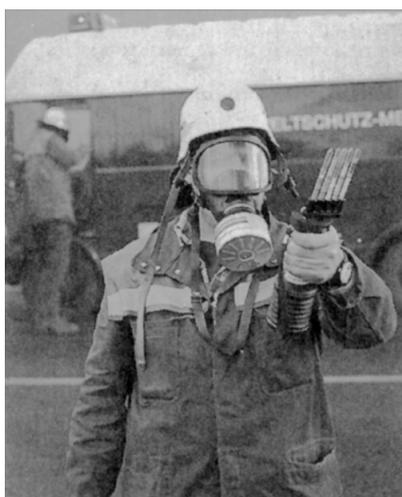
**Abb. 25.** Vor-Ort-Analyse von Brandgasen mit DRÄGER-Röhrchen-Set.
