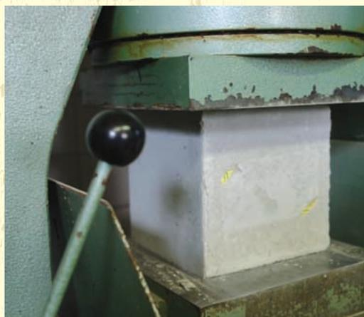
Die Rezepturen für die RC-Betone wurden mit dem Ziel entwickelt, bei vergleichbaren Eigenschaften nicht mehr Bindemittel bzw. Zement einsetzen zu müssen. Dies ist in der Praxis hervorragend gelungen und vor allem darauf zurückzuführen, dass die erzeugten RC-Gesteinskörnungen die Eigenschaften der Primärkörnungen aufwiesen.
