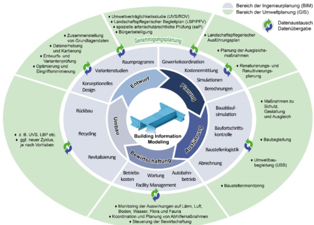
Abb. 6: Der BIM-GIS-Cycle (SCHALLER et al. 2020)
