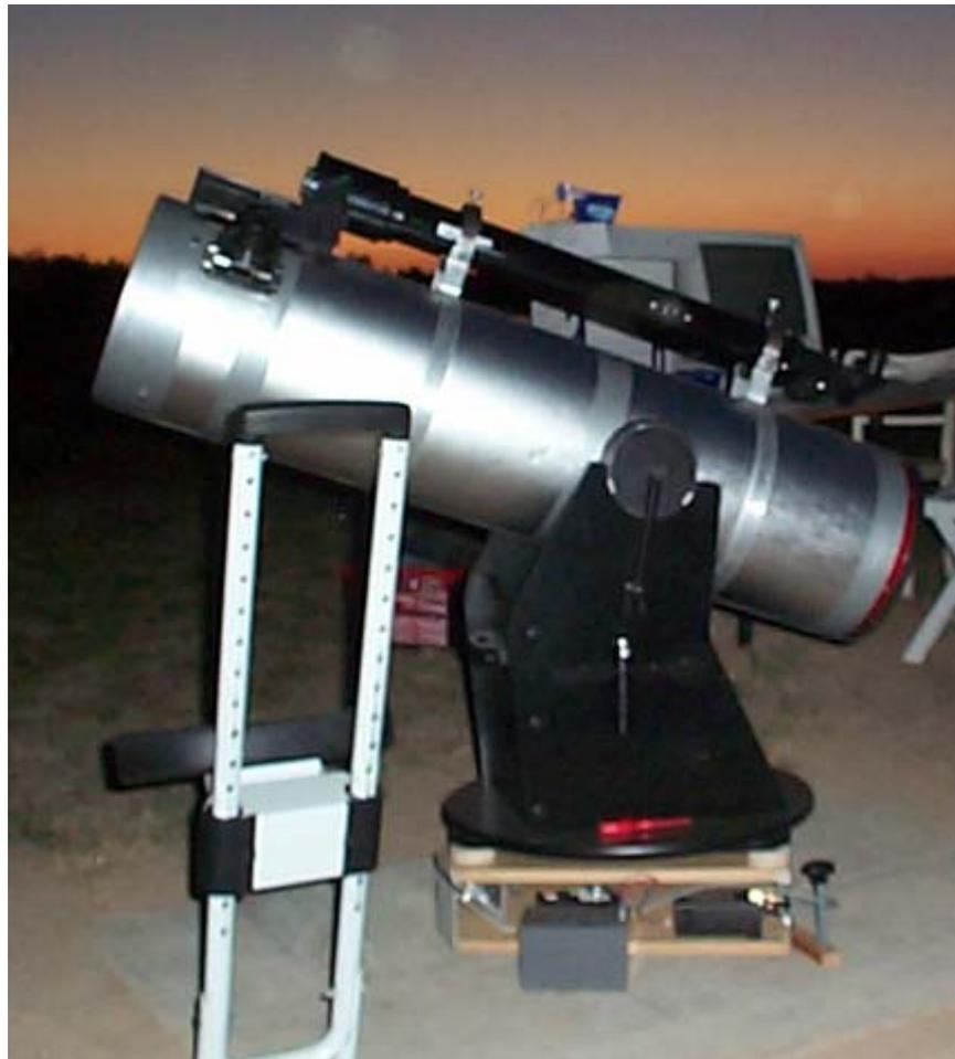
Diese Ausrüstung musste bereits ein bis zwei Stunden vor der eigentlichen Aufnahme aufgestellt werden. Der Grund hierfür liegt wieder, neben der Verformung eines sich abkühlenden Spiegels, der während der Aufnahme zu Unschärfen führen kann, bei dem schlechten Seeing, das von der aufsteigenden Wärme des Spiegels ausgeht.
