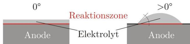
**Abb. 3.64** Kontaktwinkel und Reaktionszone
