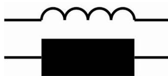
**Abb. 3.5** Schaltzeichen einer Spule
