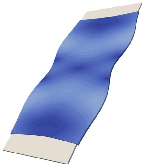
Figure 3: Snapshot du procédé d'estimation. En gris, la plaque est représentée dans sa déformation cible. En couleur, une estimation partielle faite en arrêtant le procédés d'estimation avant sa fin.
