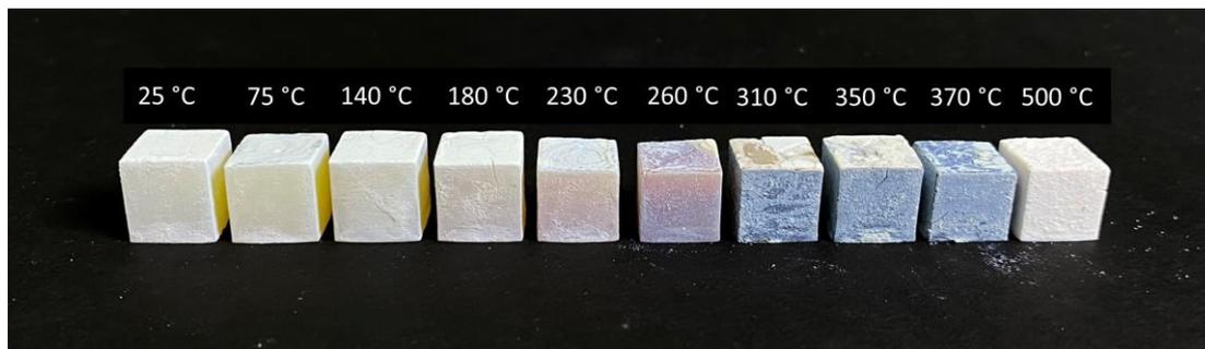
**Abbildung 5.44:** Druckerzeugnisse nach dem Abbruchentbinderungsverlauf bis zur jeweiligen Temperatur inklusive der zugehörigen Haltezeit von EV2 und zusätzlich bei einer Temperatur von 310 °C ohne Haltezeit. Die ursprüngliche Kantenlänge der Würfel beträgt 1 cm.
