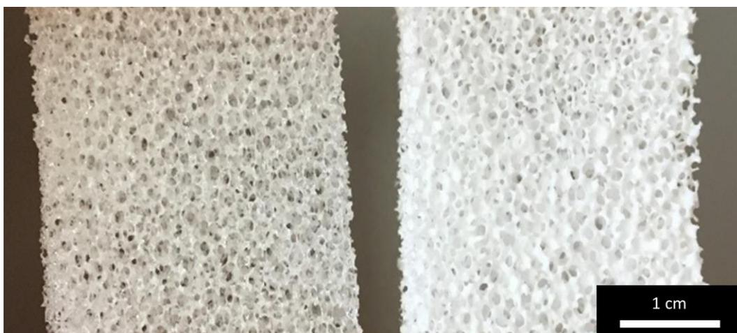
**Abbildung 6.2: Schwammstruktur aus amorphem Siliziumdioxid (links) und aus kristallisiertem Cristobalit (rechts).**
