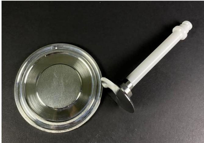
**Abbildung 4.2: Platte und Rotor mit Kegelspitze mit einem Winkel von  $2^\circ$**
