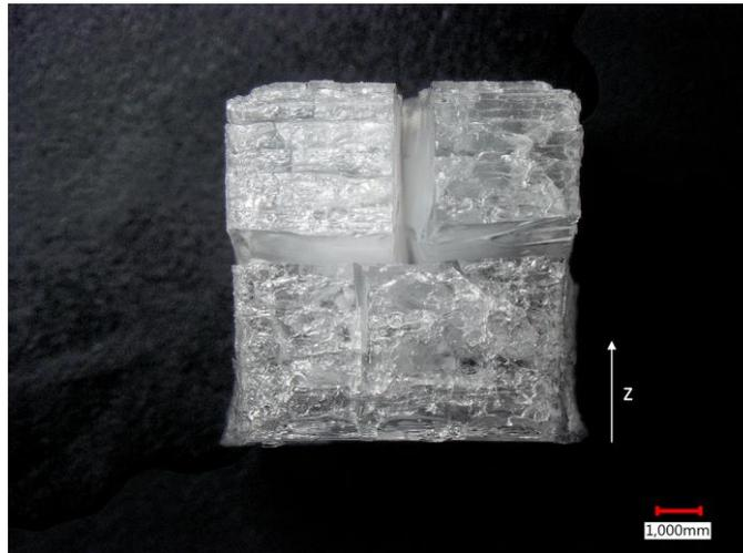
**Abbildung 5.47: Lichtmikroskopische Aufnahme des Würfels mit 40 Vol.-% Feststoffanteil nach der Sinterung (SV1) im optischen Dilatometer. Die Druckrichtung verläuft von der unteren Seite des Bildes zur oberen (z).**
