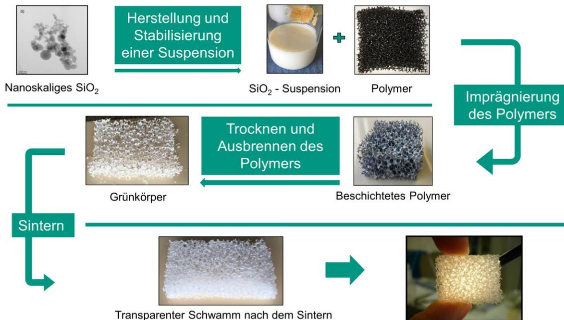
**Abbildung 2.10: Schematischer Verlauf des Replika-Verfahrens nach Schwartzwalder und Somers [3].**
