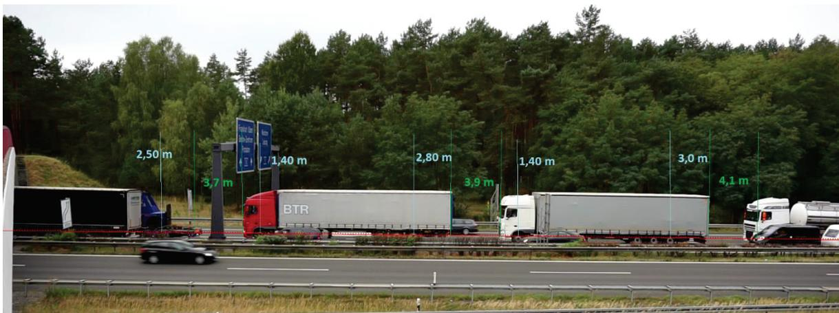
Abbildung 2.15: Erfassung der Stauabstände (Fahrzeugüberstände und Fahrzeugabstände), AD Potsdam (A10) [FBKGK18]
