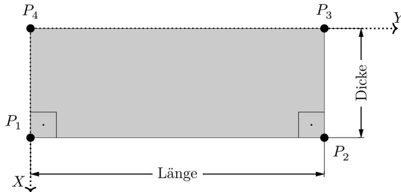
**Abbildung 8.2:** *Parameter* und *Constraints* der Unterseite der *Rechteck-Wand* in der XY-Ebene (Draufsicht).
