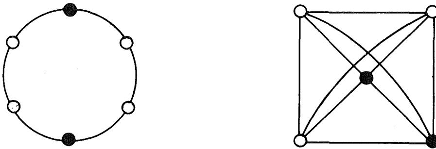
Abb. 1.2-1 Beispiele für homogene symmetrische Rechnernetze. Die gefüllten Kreise kennzeichnen die optimale Verteilung einer Datenbank mit zwei Komponenten.
