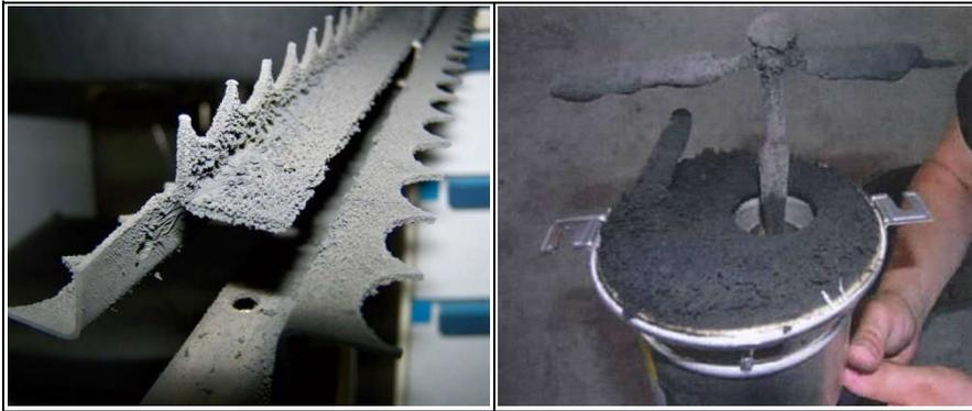
Bild 1: typische Belegung von Sprühelektroden (li.: [ 7], re.: [ 80])
