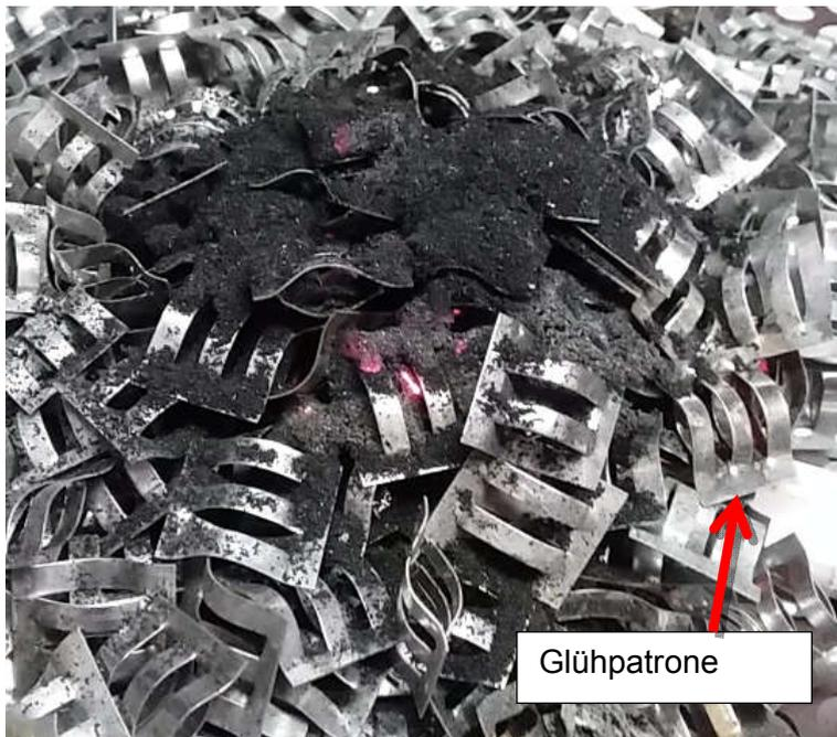
Bild 27: Glühfronten der Abreinigung durch Abbrennen
