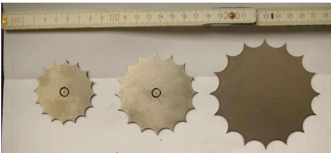
Bild 3: Größenvarianten der Sprühelektrode
