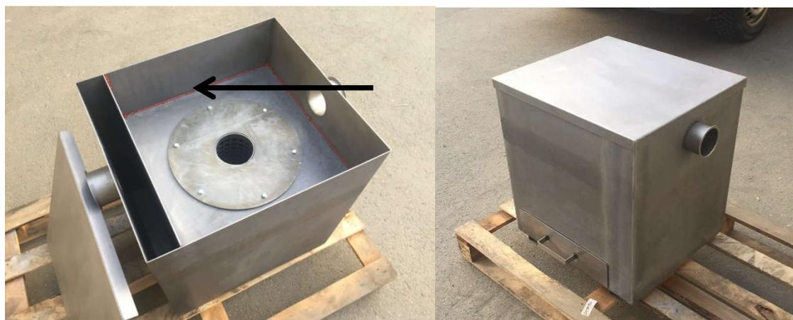
Bild 18: gefertigtes Abscheider-Versuchsmuster
