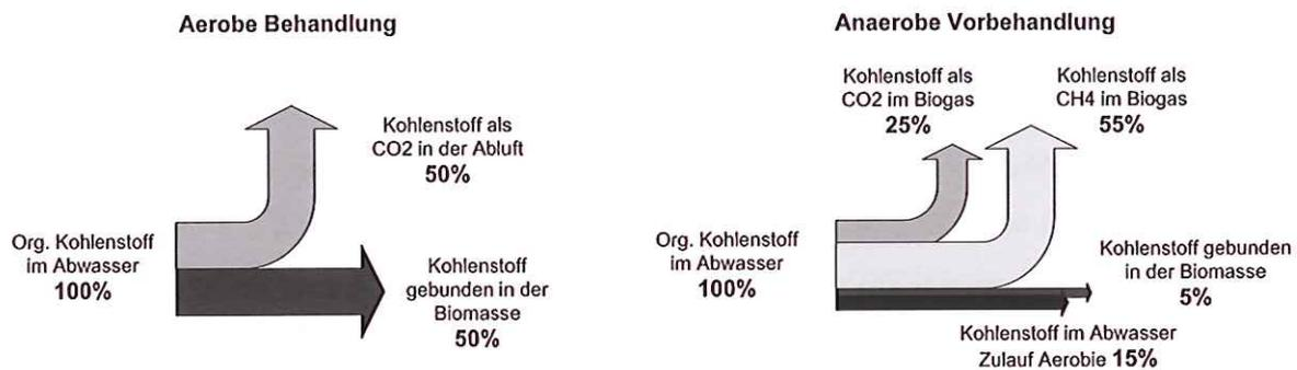
Abbildung 1-1: Prinzipieller Vergleich der C-Bilanzen anaerober und aerober Kohlenstoffeliminationsverfahren, aus Beier et al. (2008)
