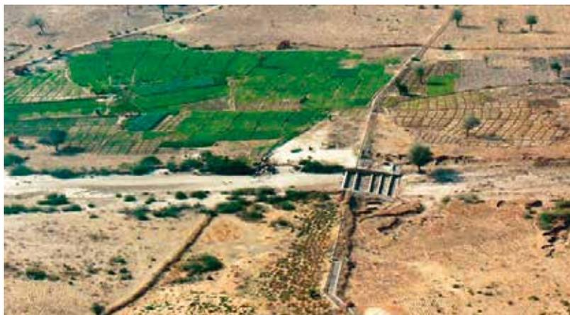
Luftaufnahme einer Flussschwelleanlage in Abeché im Tschad. Deutlich zu sehen ist der positive Einfluss der Anlage auf den Wasserhaushalt der Böden, der zu einer Verbesserung der landwirtschaftlichen Produktivität führt. Auf diese Weise können bis zu drei Anbauzyklen pro Jahr realisiert werden.
