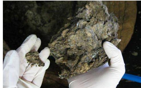
Der im Vorfeld kritisch betrachtete manuelle und zeitliche Aufwand für die Entleerung der Separatoren hat sich als erfreulich gering herausgestellt. Durch Sektionsmitglieder wurden alle 3 Separatoren entleert und die Reststoffe für den Abtransport vorbereitet. Durch den hohen TR-Gehalt und die Lagerzeit über den Winter hinweg, wurden die Reststoffe weder in Hinsicht auf Geruch noch Konsistenz als unangenehm empfunden. Der Zeitaufwand für Entleerung betrug:
