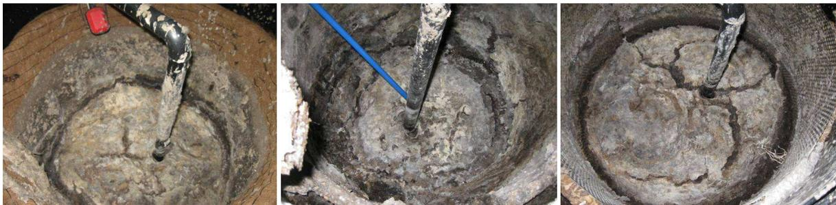
Abbildung 30: Fäkalschlammseparatoren mit verschiedenen Hinterfüllmaterialien (von links: Kokosfasermatte 400 g/m<sup>2</sup>, Geotextil 400 g/m<sup>2</sup>, Holzhackschnitzel)
