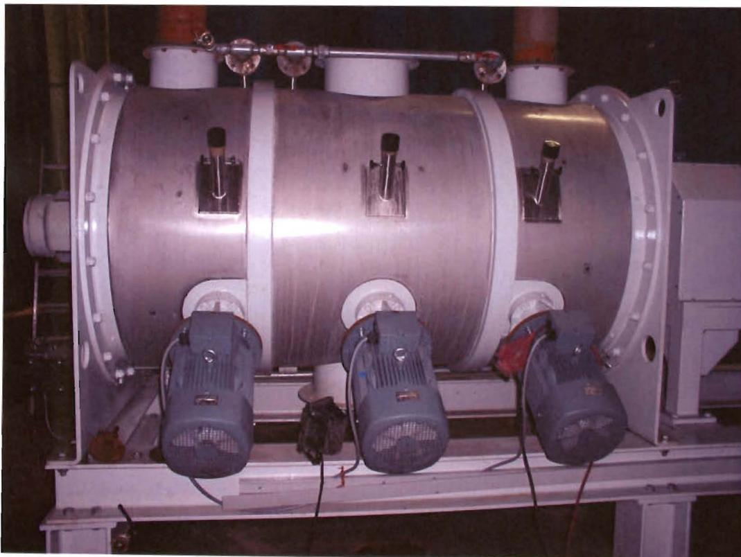
**Bild 6: Pflugscharmischer – Veränderung der Wasserzufuhr / Umstieg auf Eindüsung**
