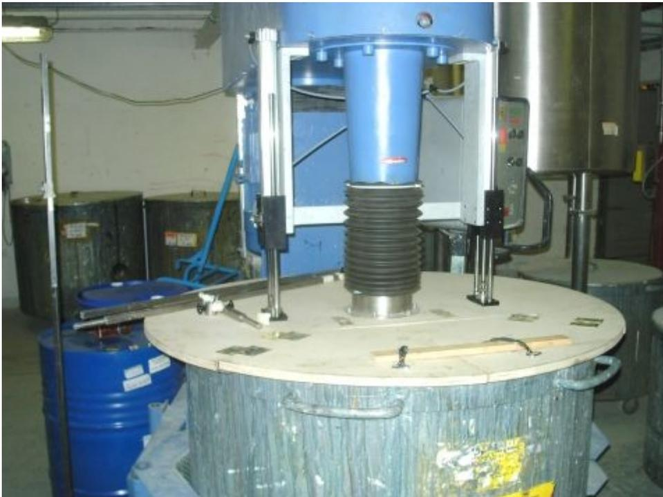
Bild 2: Deckel zur Abdichtung der Behälter mit Bedienöffnungen und pneumatischer Führung
