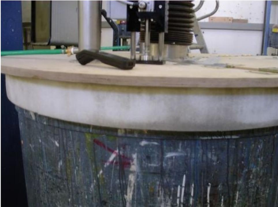
Bild 13: Erprobung eines Deckels aus Holz mit Schaumstoffdichtung und Rückflusskühler (Tabelle 5)
