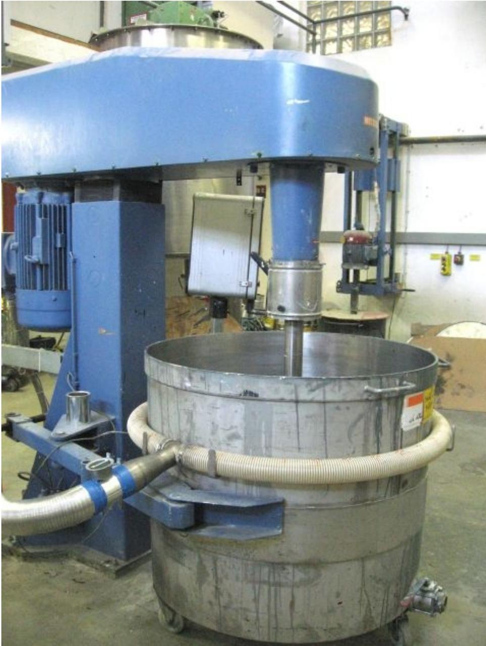
Bild 16: Anströmung der Zuluft an die Behälterwand; Ausbildung der Absaugung als Senke oberhalb des Emittenten; Quellauslass als ringförmiger Anströmer ausgebildet (Tabelle 8)
