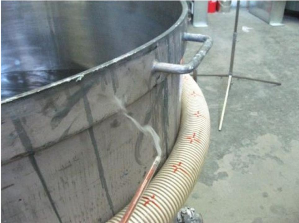
Bild 17: Wirkung des Luftschleiers. Die geringe Luftströmung bildet einen einhüllenden Luftschleier, der in die Senke oberhalb des Rührorgans mündet.
