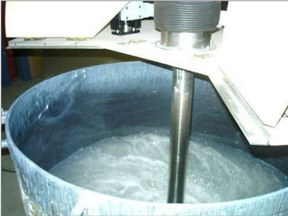
Bild 3: Deckel mit Bedienöffnung im angehobenen Stand
