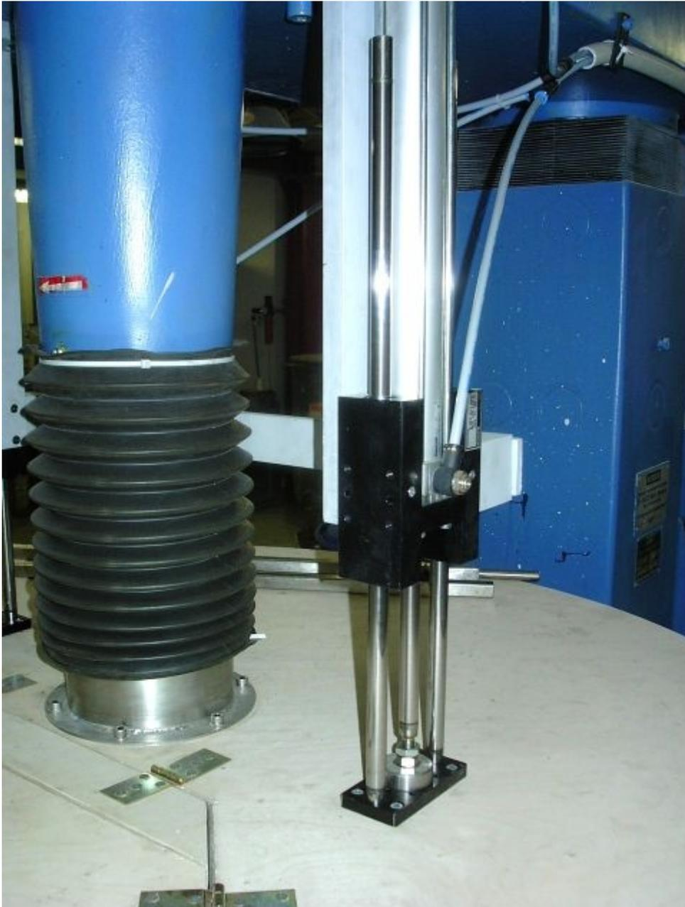
Bild 4: Deckel mit pneumatischer Führung und Abdichtung gegen die Welle
