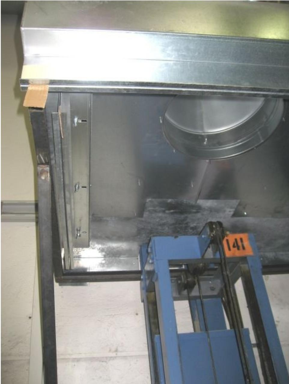
Bild 7: Die Schlitzdüse der Fangplatte ist in ihrer Breite variabel einstellbar. Somit wurde es möglich, unterschiedliche Luftvolumen und unterschiedliche Luftgeschwindigkeiten in den Luftschleiern zu erproben.
