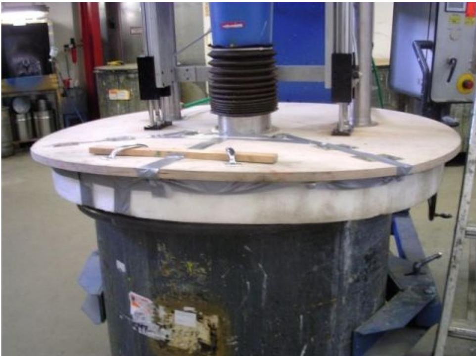
Bild 11: Erprobung eines Deckels aus Holz mit Schaumstoffdichtung (Tabelle 3)
