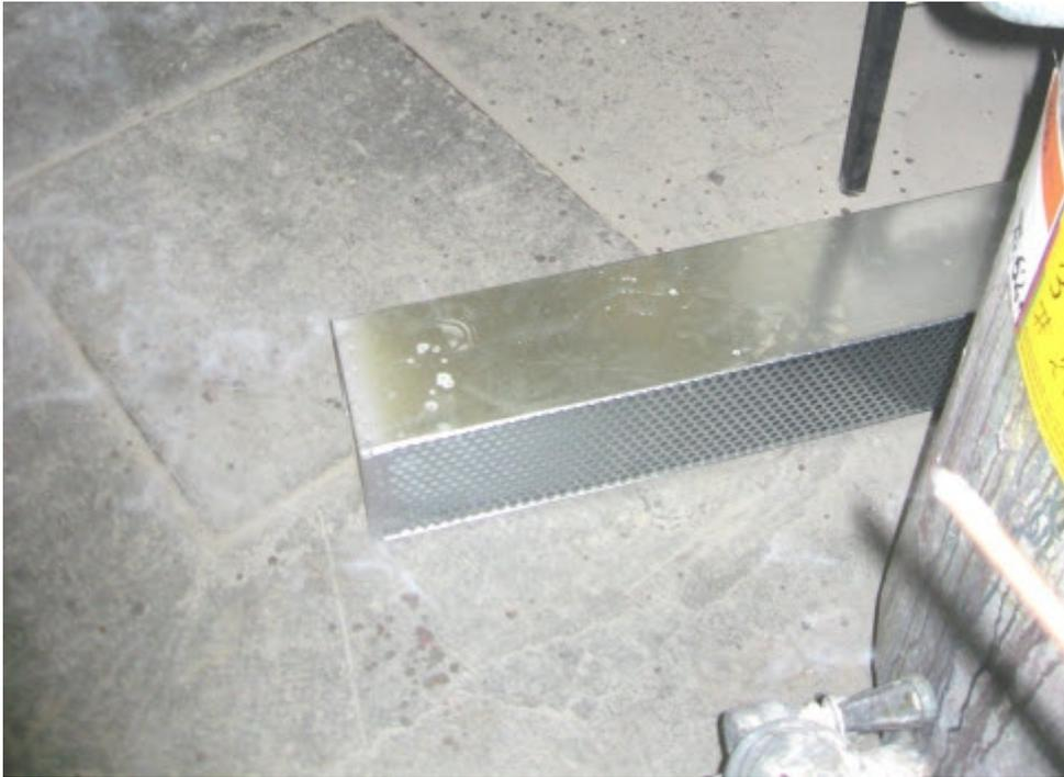
Bild 5: Quellauslass (aus Lochblech gefertigt) zur unterschiedlichen Verwendung und Prüfung der Strömungsversuche
