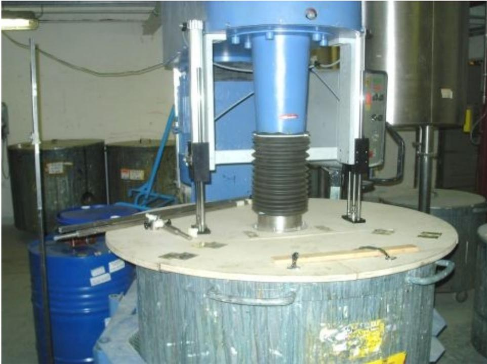
Bild 10: Erprobung der Dichtigkeit und des Austritts von Lösungsmitteldämpfen (Tabelle 2)
