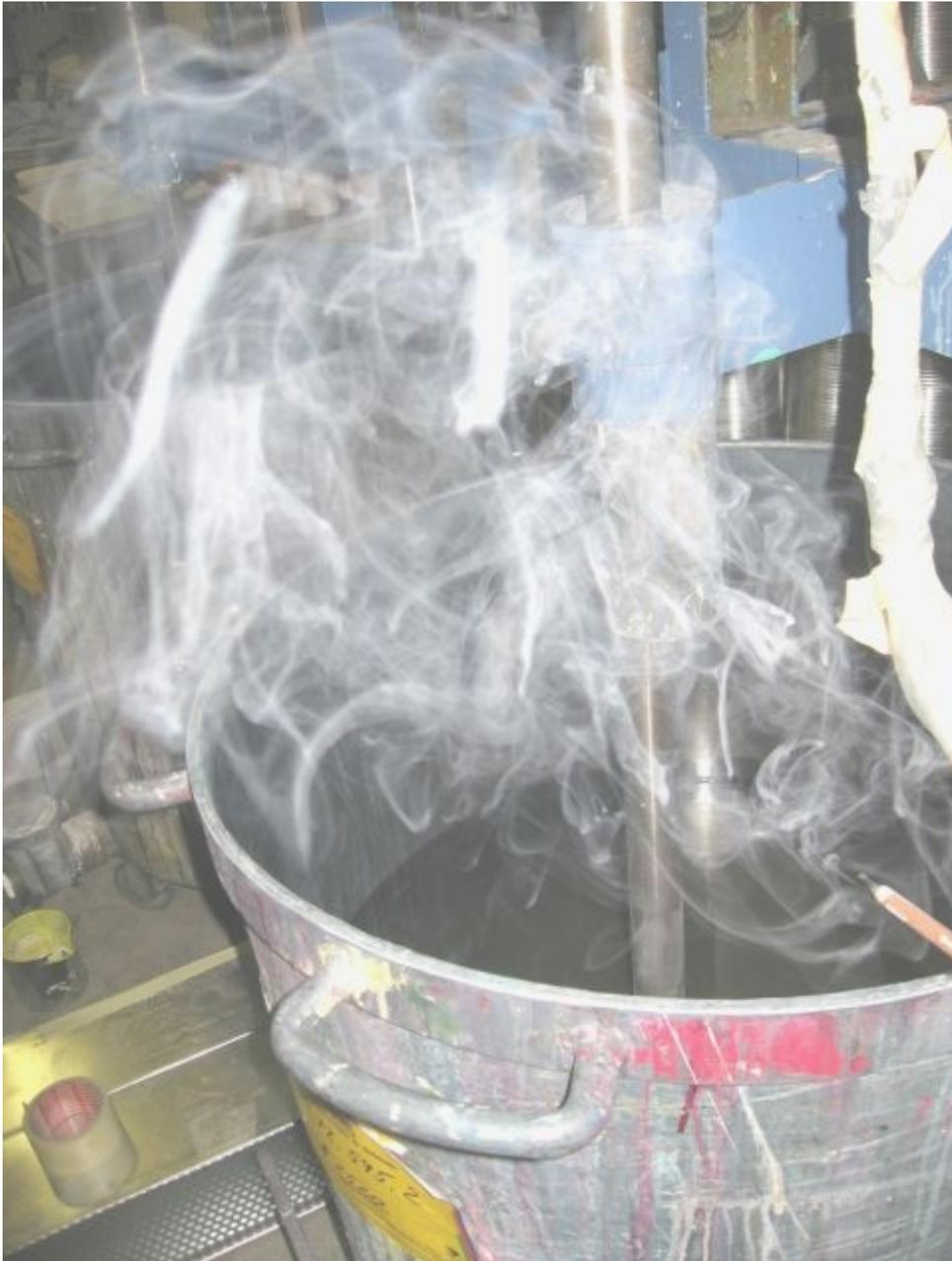
Bild 15: Luftströmung nach oben. Die Luft strömt durch Einwirkung der Thermik und der Turbulenzen der Mischvorgänge vertikal nach oben. (Tabelle 7)
