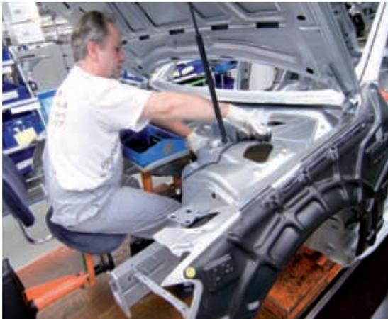
© Foto AUDI Kommunikation, ergonomischer Montagesitz in der A4-Fertigung
