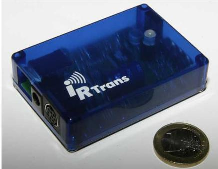
Abbildung 27: IRTrans USB Modul, Infrarot Sender und Empfänger
