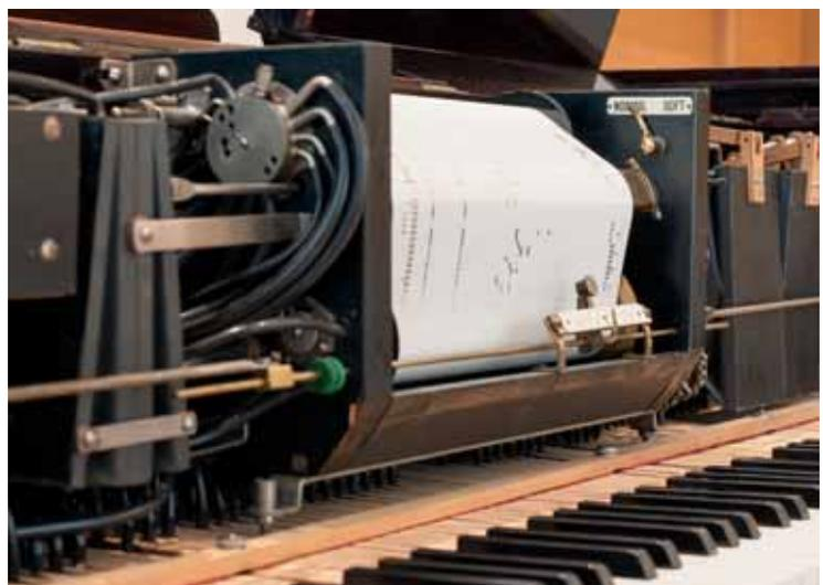
Elektro-pneumatischer Flügel, Steck/Aeolion, Detail Unterdruckschläuche, Klavierrolle, Saugbälge;
