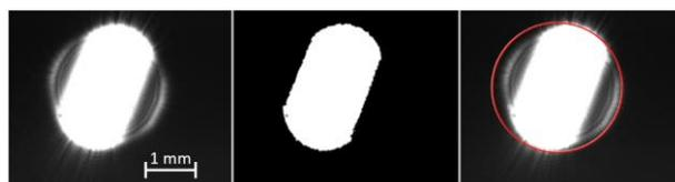
**Abb. 3** Links: Intensitätsverteilung des Diodenlasers auf der Messkamera; Mitte: Anpassung des Kontrasts; Rechts: Erfassung des Durchmessers (roter Ring)
