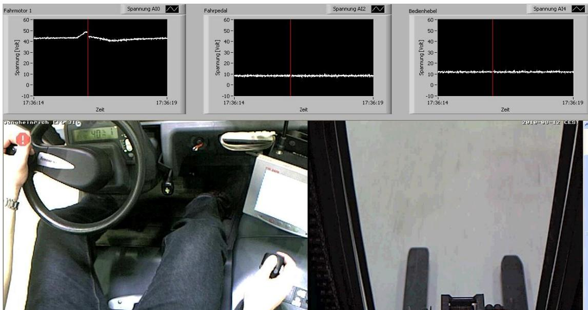
Abbildung 7: Benutzeroberfläche mit eingebundenem Kamerasystem während der Datenaufzeichnung
