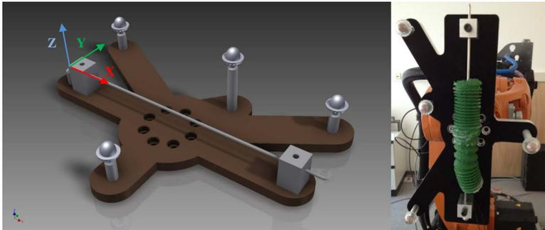
Abbildung 32: Lokator zur Feststellung der Manipulatorpose
