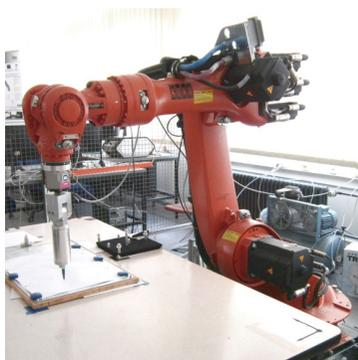
*Abbildung 8: KUKA KR16 Industrieroboter*
