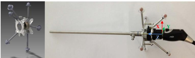
Abbildung 31: Lokator zur Feststellung der Kamera-Pose
