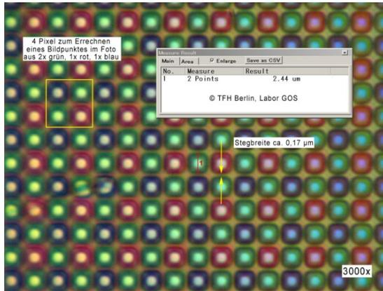
Abbildung 18: Aufnahme der Pixelmatrix eines CCD-Chips unter dem Mikroskop (3000x), Pixelgröße  $\approx 2,5\mu\text{m}$ , Autor: Beuth Hochschule für Technik, Labor für Gerätetechnik, Optik und Sensorik, Berlin
