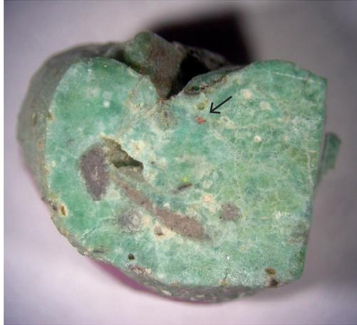
Abb. 11 Bild Metallspan in Probe G 2 (Länge der Bildkante: ca. 2,1 mm)
