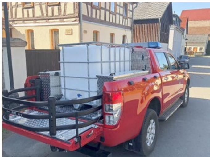
Mit einem 600l-Wechseltank soll das Fahrzeug speziell für den kleine Wald- und Feldbrände bzw. für Nachlöscharbeiten in unwegsamem Gelände eingesetzt werden. Durch die fest montierte Anhängerkupplung kann aber auch ein Tragkraftspritzenanhänger gezogen werden, so dass dieses Gespann das ehemalige Kleinlöschfahrzeug optimal ersetzt.
