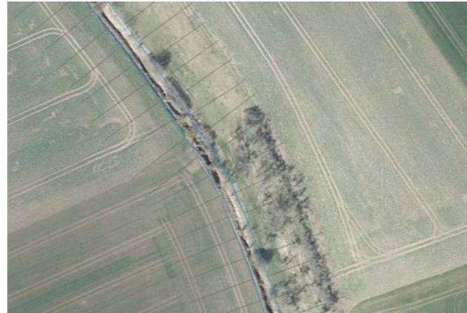
Abbildung 2: Segmentierte Böschungsoberkanten mit versehenen Lotlinien
