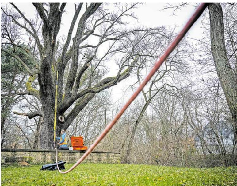
Ein Zugversuch simulierte eine starke Windlast.
