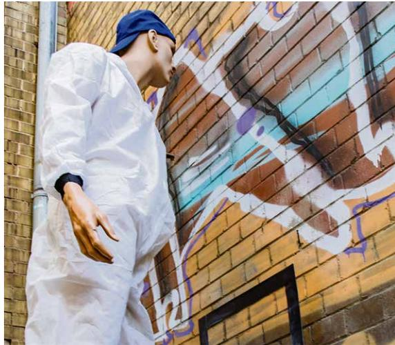
Zum Testen wurde der superhydrophobe Lack innerhalb der schwarzen Abgrenzung auf die Hauswand aufgetragen. Eine Puppe simulierte den „Wildpinkler“. Im Ergebnis konnte die Test-Flüssigkeit nicht in die Wand eindringen, sondern perlte ab und spritzte auf die Schuhe der Puppe.
