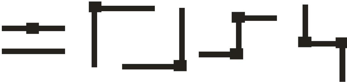
**Abbildung 5.3: Via-Positionen der Verdrahtungselemente**
