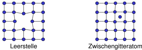
Abbildung 4.3: Nulldimensionale Gitterfehler.
