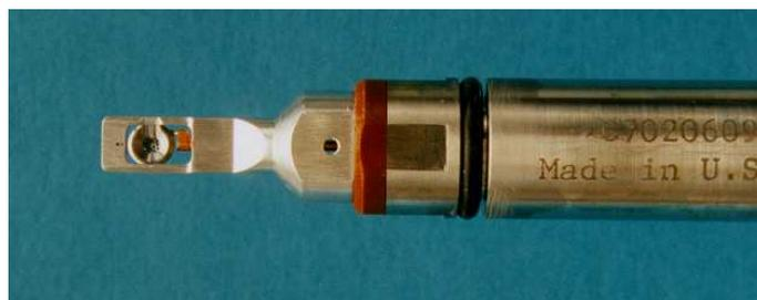
Abbildung 6.4: Doppelkippprobenhalter des JEM 2010.
