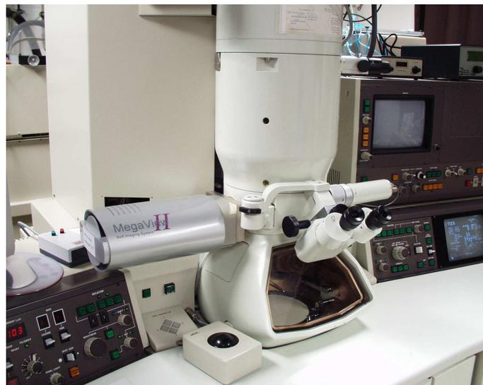
Abbildung 6.6: Digitales Kamerasystem des JEM 2010.
