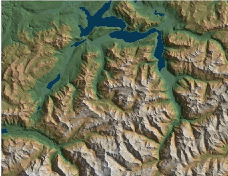
Abb. 4-13: Schummerungsdarstellung eines Ausschnitts der Schweizer Alpen. Die Schummerung bewirkt eine schattenplastische Darstellung der Reliefformen. Trotz unterschiedlicher Helligkeit der Flanken wird keine Farbveränderung assoziiert. Dies ist ein Indiz für Helligkeits- und Farbkonstanz bei der Betrachtung der Abbildung (© Atlas der Schweiz, © DHM 25 Landestopographie Wabern).
