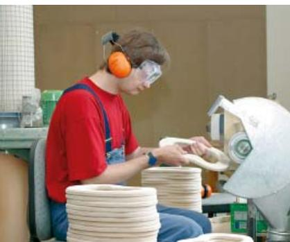
Schleifen eines Werkstücks
