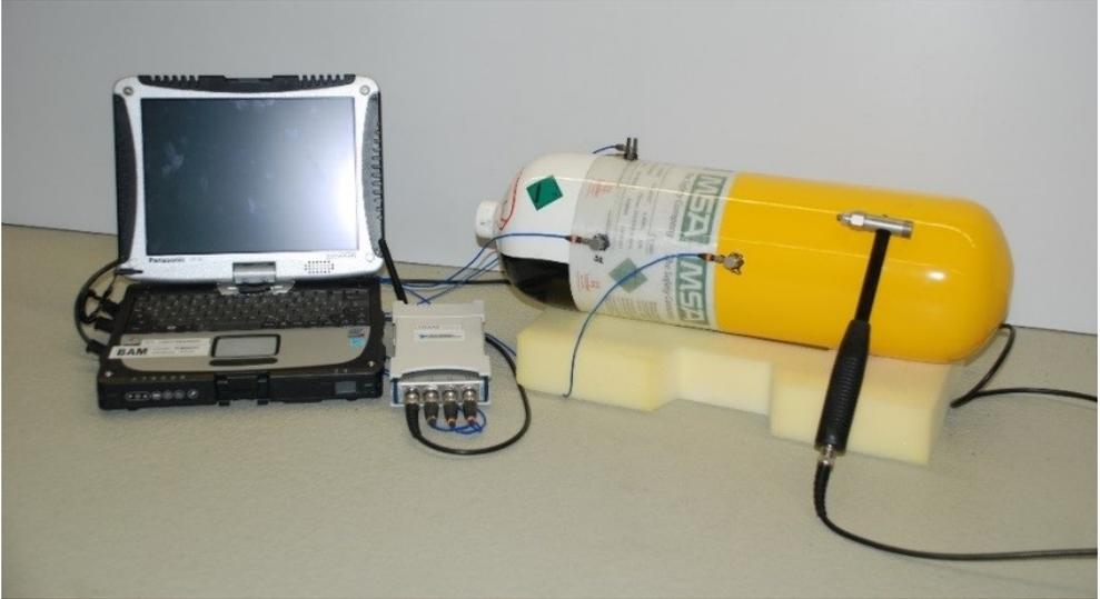
Abbildung 3.18: Aufbau des EMA-Prüfstandes
