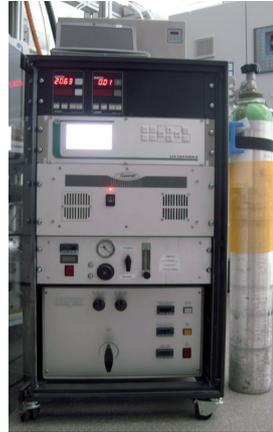
Abbildung 5.2 FTIR-Messschrank des IFF. © IFF.
