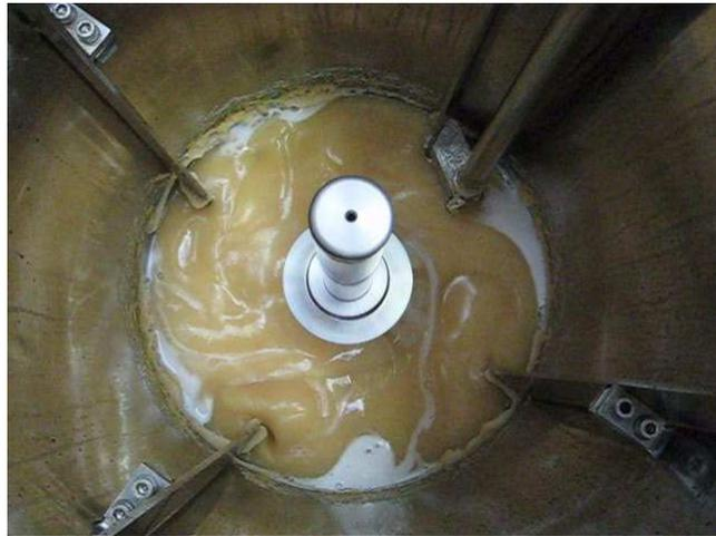
Abbildung 5.6 Aufsicht auf 100 L Kulturbrühe bei aktiver Begasung (20 – 25 NL min<sup>-1</sup>) des Bioreaktors nach 4 Tagen Kulturdauer
