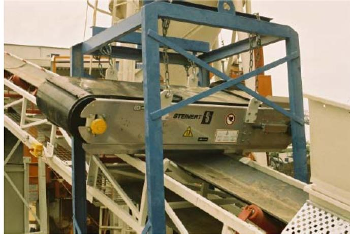
Abbildung 6: Permanentüberbandmagnet der Fa. Steinert [KOHAUPT]
