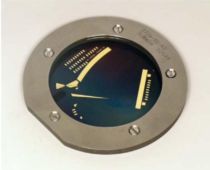
Abb. 4-7: Auf der Basis von gegossenem PMMA hergestellte Titan-Arbeitsmaske (Losnummer 02548)
