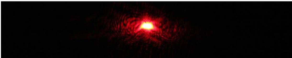
Abb. 5-6: Aufnahme des Reflexes bei Laserbeleuchtung des Ulenkspiegels aus Silizium
