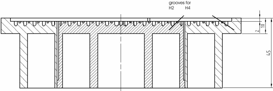
Fig. 3.4. Heater plate H2-H4.
