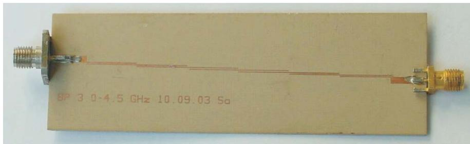
Abbildung 6.17.: Das realisierte Bandpassfilter 2,95–4,35 GHz.
